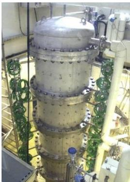
Fig. 1 – Réservoir de stockage avant isolation.
