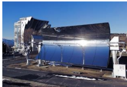
Figure 1 : Cylindro-parabolique n°1 de l'installation MicroSol-R (PROMES-CNRS)
